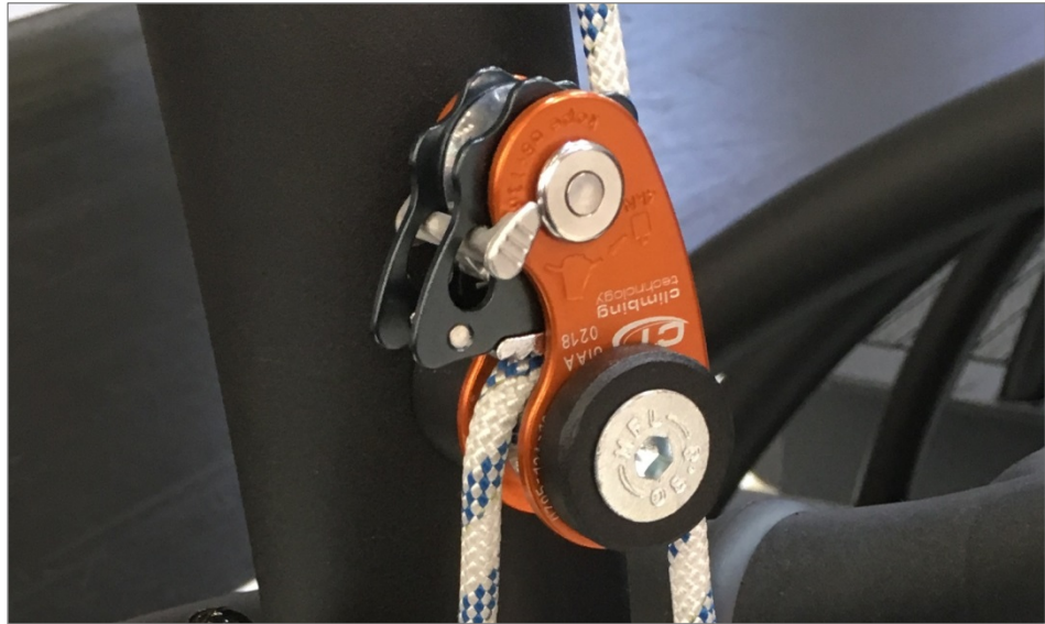
Abb. 10 Seil Arretierung, Sperrklinke verriegelt
